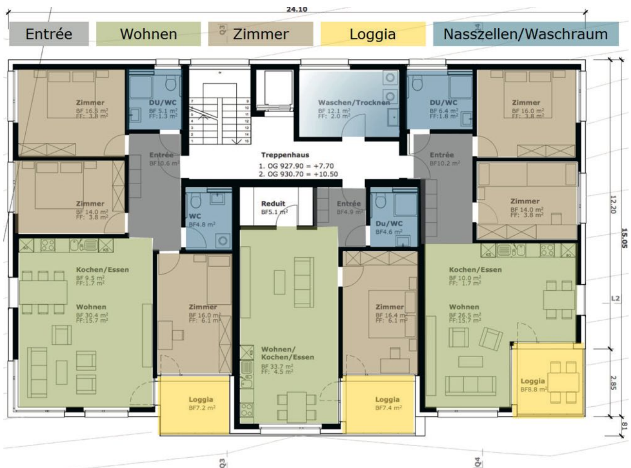
Grundrisskonzept Haus Ost 1. und 2. Obergeschoss.
